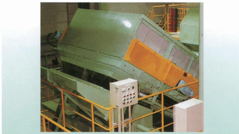
MIIKE ベルトセパレーターは、吸引口(処理物を吸い付けるための小さな穴)の付いたコンベヤベルト・振動装置・送風機等により構成されており、処理物を軽量物と重量物、そして吸引口より吸い出されたダスト(小粒子)の3種類に選別する選別機です。振動フィーダー等の供給装置から投入された処理物はコンベヤベルト上に落ちます。コンベヤベルトの裏側は吸引ファンによって吸引されており、シート状の廃プラや紙屑、発泡トレイ等はコンベヤベルトの吸引口に吸着して上へ運ばれ、軽量物シュートから排出されます。ビン・缶・ペットボトル等の転がりやすいものや石・コンクリート・金属等の比重の重いものはコンベヤベルトを滑り落ちて重量物シュートへ排出されます。吸引口より吸い出された土砂等の小粒子はスクリーンコンベヤによってダストボックスへ排出されます。また、重量物が軽量物に絡まって軽量物側に排出されたりするのを防ぐために振動装置を設置しており、ベルトの振動で処理物をほぐすことにより選別精度を向上させています。
